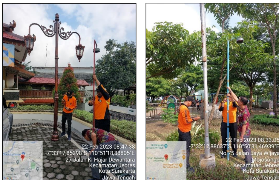
Gambar 3.15. Pemantauan Kualitas Udara Ambien Metoda Passive Sampler Pada Area Pemukiman Dan Perkantoran
